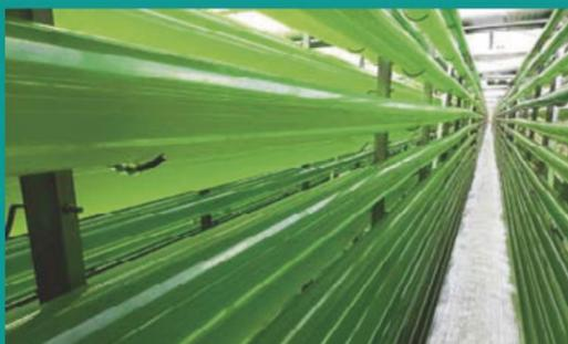
La chlorelle est cultivée sur le site de production basé à Plougenast (22), dans une solution maintenue à 25 °C, dans laquelle sont injectés du CO<sub>2</sub> et des nutriments, notamment de l'azote.
